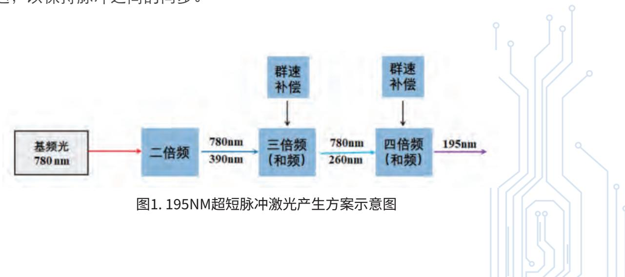
图1. 195NM超短脉冲激光产生方案示意图
